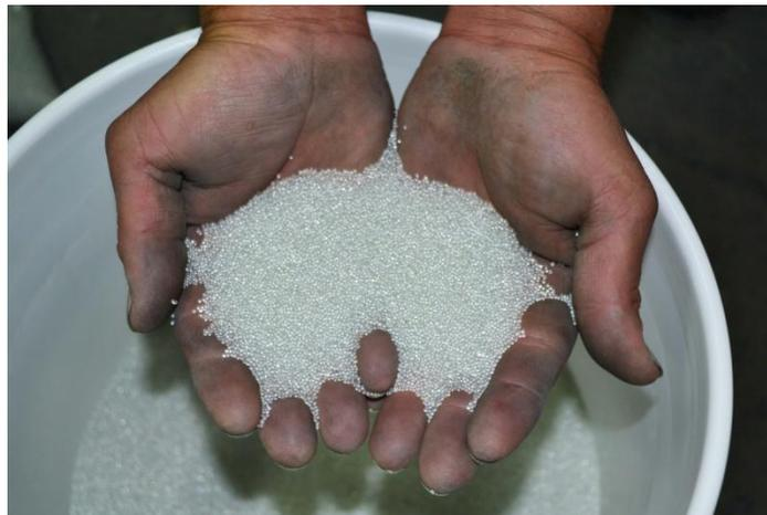
Imagen 8: Arena sílica utilizada en el molino de arena
